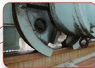
除塵機設備の車輪破損
